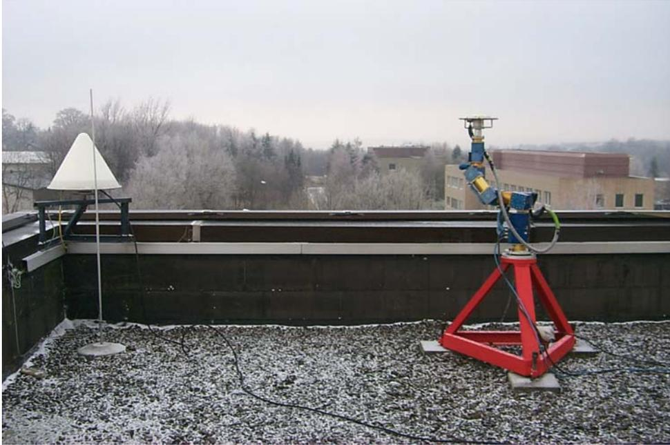
*SAPOS-Referenzstationskalibrierung in Clausthal. Links: GPS-Antenne mit Wetterdome; Rechts: Roboterarm auf mobiler Montierung.*
