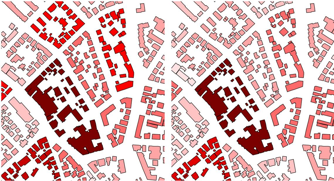
Abb.: links: mit Laserscanning, ALK und Gebäudetypologie berechneter Wärmebedarf für Stuttgart, Stadtteil Wangen; rechts: aus dem Wärmekataster übernommener Wärmebedarf zum Vergleich; der Wärmebedarf ist jeweils für Baublöcke zusammengefasst.
