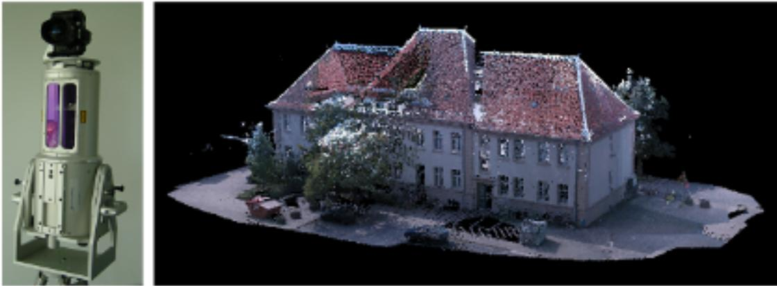
Abb. : Laserscanner (links), 3D-Punktwolke (rechts)
