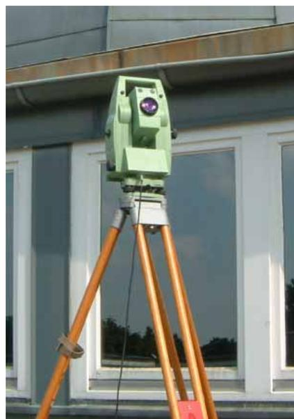
Ein Robottachymeter der Firma Leica Geosystems
