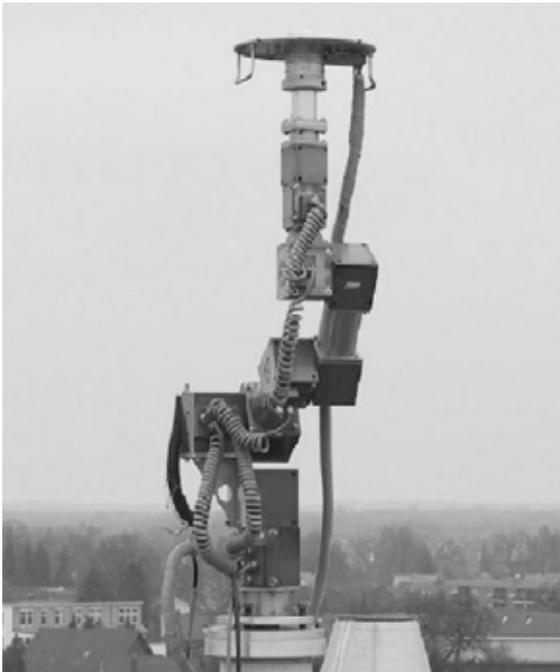
Roboterarm zur Stationskalibrierung
