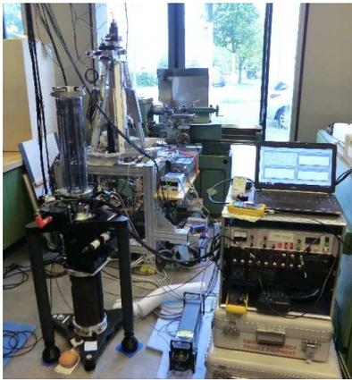
**FG5X-220 (VORDERGRUND) UND GAIN (HINTERGRUND) BEI PARALLELER MESSUNG IN BERLIN**
