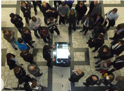
Am IPI wurde im Rahmen des Projektes ein Modul zur stereoskopischen Rekonstruktion von Personen entwickelt und in das Gesamtsystem integriert. Anhand der erfassten Messdaten können genaue Angaben zu Position und Größe von Personen gemacht werden. Außerdem erlauben die erhobenen Daten die Zuordnung von Trajektorienstücken zwischen benachbarten Kameras sowie eine Analyse der Interaktion von
