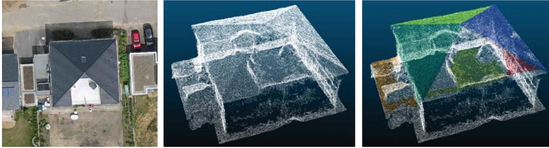
ORTHOPHOTO (LINKS), 3D-PUNKTWOLKE (MITTE) UND SEGMENTIERTE DACHFLÄCHEN (RECHTS)
