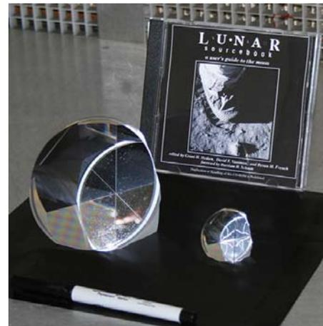
**GRÖßENVERGLEICH ZWISCHEN EINEM NEUEN LLRRA-21 EINZELPRISMA UND DEM PRISMA AUS EINEM REFLEKTOR-ARRAY DER APOLLO-MISSIONEN**
