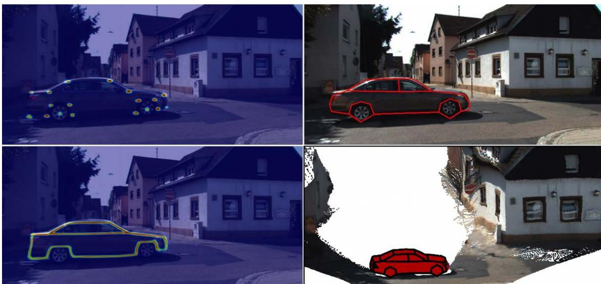
BEISPIEL EINES EINGEPASSTEN FAHRZEUGMODELLS. LINKS: DETEKTIERTE LANDMARKEN (OBEN) UND PRÄDIZIERTE FAHRZEUGKANTEN (UNTEN). RECHTS: EINGEPASSTES FAHRZEUG PROJIZIERT INS BILD (OBEN) UND IN 3D ANSICHT (UNTEN).
