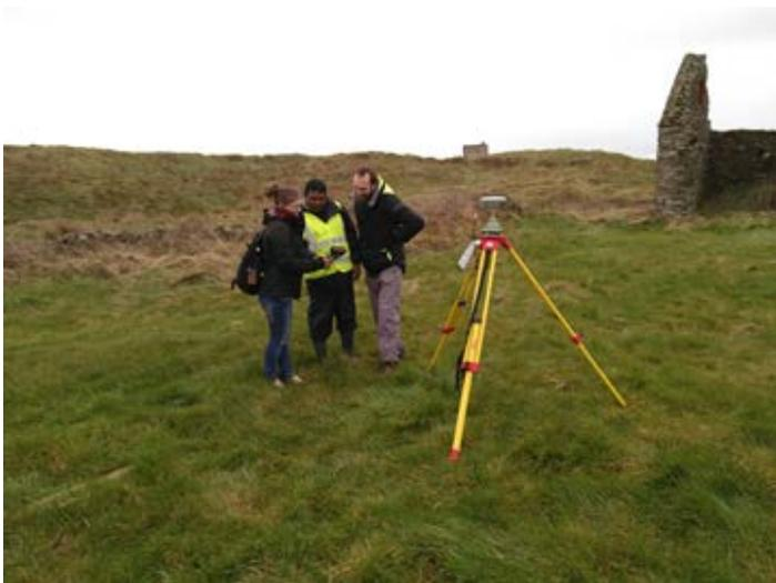
**EINRICHTEN EINER GNSS BASISSTATION FÜR DAS POSTPROCESSING DER DROHNENDATEN FÜR DIE DURCHFÜHRUNG EINES DROHNENFLUGES RUND UM KILMICHAEL POINT, SÜDLICH VON DUBLIN**
