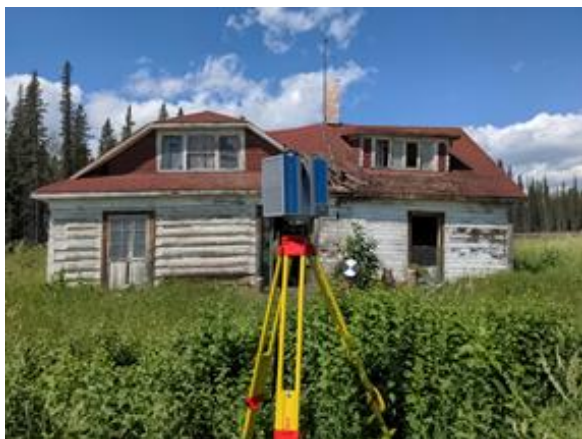
LASERSCANNING AUF DER BAUSTELLE DES SPRINGBANK RESERVOIR. DIESE FLÄCHEN WERDEN ZUKÜNFTIG ALS ÜBERSCHWEMMUNGSGEBIETE BEI HOCHWASSER BENÖTIGT.
