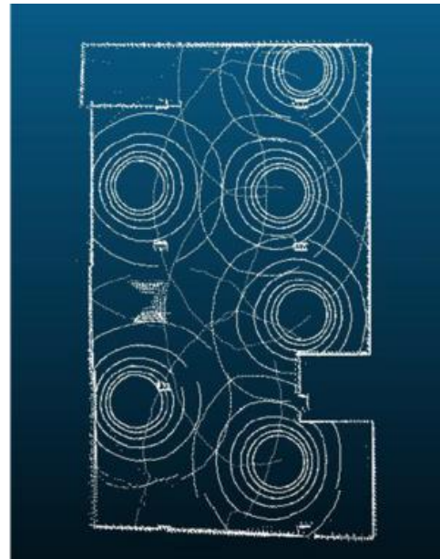
CAD-MODELL EINER MITTELS TERRESTRISCHEN LASERSCANNER ERFASSTEN REFERENZUMGEBUNG (LINKS) SOWIE STANDPUNKTPLANUNG FÜR EIN LASERSCANNER-BASIERTES MONITORINGSYSTEM (RECHTS).
