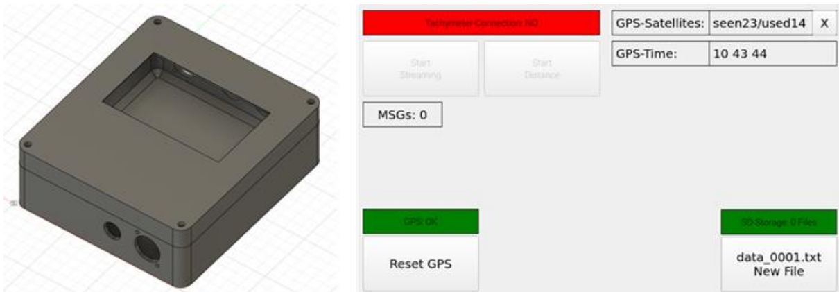
3D-DRUCK DER SYNCHRONISIERUNGSBOX (LINKS) UND BENUTZEROBERFLÄCHE FÜR TOUCHDISPLAY (RECHTS) .
