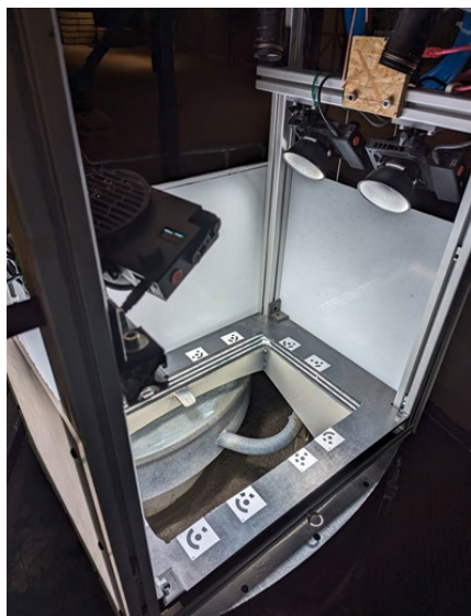
AUFNAHME DES MISCHVORGANGS MIT EINEM STEREOKAMERASYSTEM
